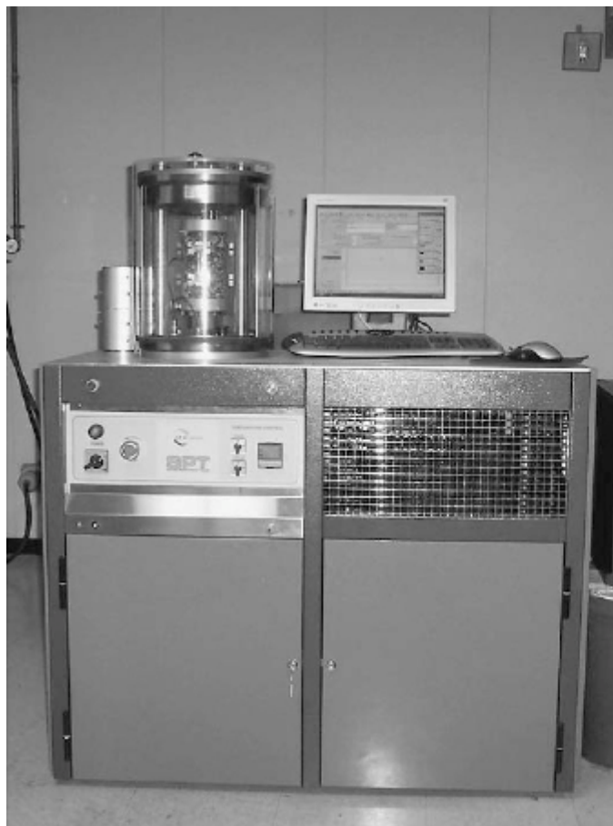
Slika 1 — Postavka SPT opreme za ispitivanje [5] Figure 1 -SPT test equipment setup [5]
